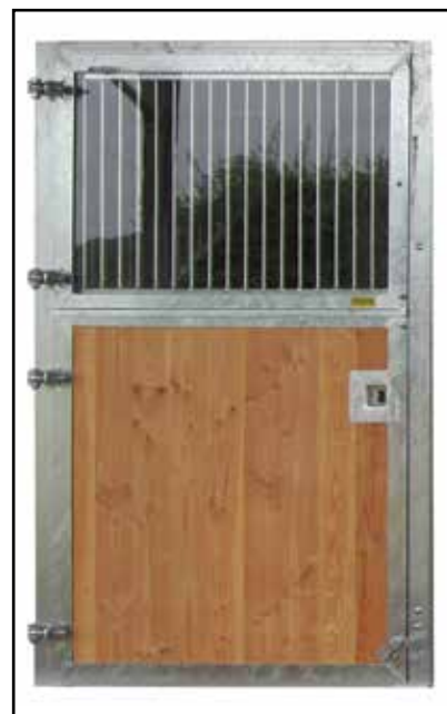
Pferdeboxen-Außentür, waagrecht geteilt, mit Douglasienvollholz und Fenster mit Plexiglas und Schutzgitter
