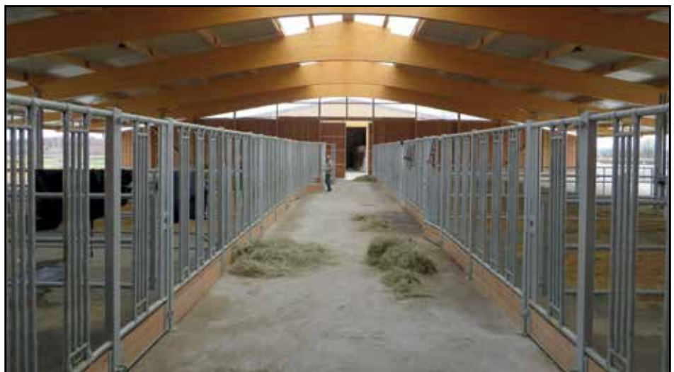
Laufställe mit Sicherheits-Durchfressgitter und Teleskopabtrennungen
