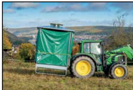
Transport über Dreipunkthängung mit eingeklappten Dachsegmenten
