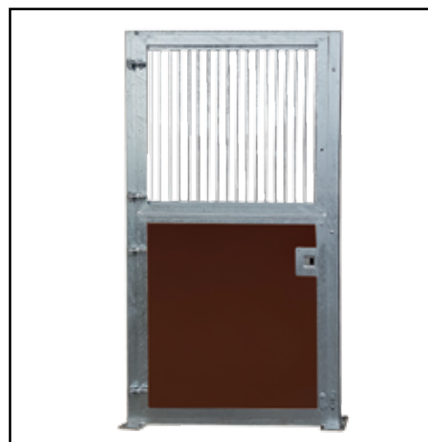
Pferdeboxen-Außentür, waagrecht geteilt, mit Resopalplatte außen, Fenster mit Plexiglas (schlagfest) und Schutzgitter
