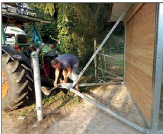
Um Verletzungen der Pferde zu vermeiden, kann die Deichsel nach dem Transport hochgeklappt werden.
