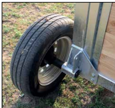
Zum Transport werden die Räder in die Halterung gesteckt.
