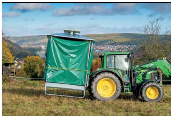
Transport über Dreipunkthanhängung mit eingeklappten Dachsegmenten
