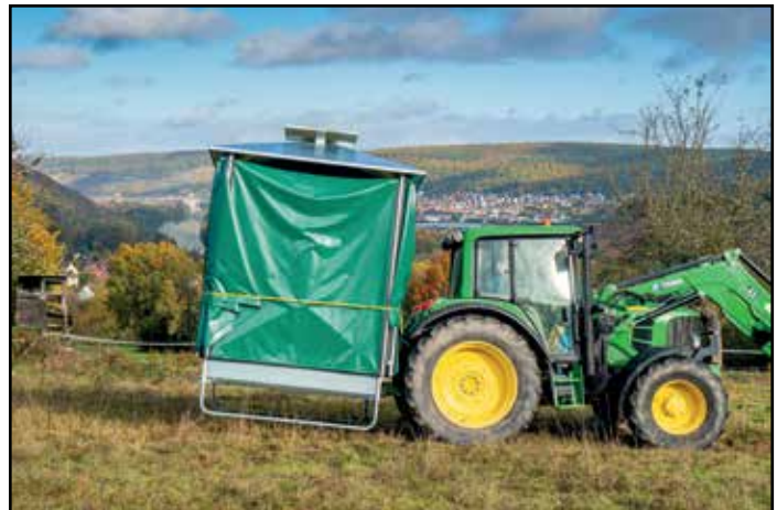
Transport über Dreipunkthängung mit eingeklappten Dachsegmenten
