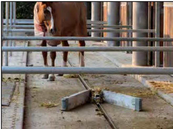
Der Schieber läuft außen am Stall im Paddock. Durch eine einbetonierte U-Schiene wird der Schieber geführt. Die Pferde müssen beim Entmisten nicht weggesperrt werden. Der Schieber läuft langsam und geräuschlos.
