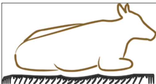
6 cm dicke Vollgummimatte mit Flügelprofil, passt sich ideal der liegenden Kuh an
