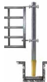
Einbauskitze mit Einbauhülse ø 140
